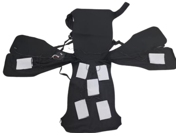
Gambar 6 Bagian dalam rompi yang telah diisi komponen elektronika dan modul pemanas
