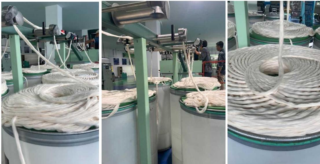
Gambar 3 Produksi *Sliver Drawing finisher*.
