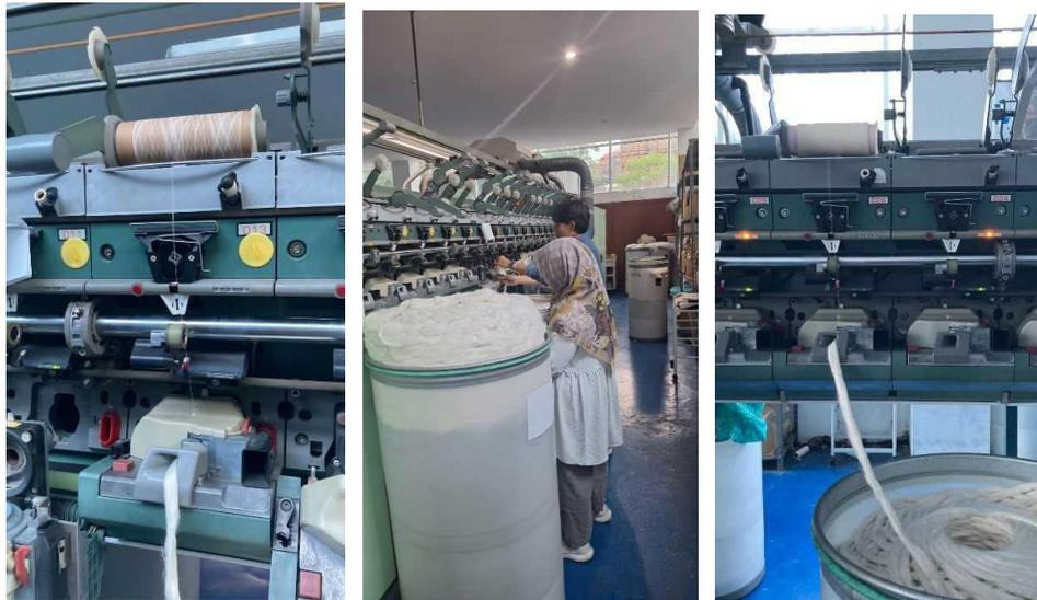
Gambar 4 Produksi Benang Campuran Nanas-Cotton dengan Mesin Open End
